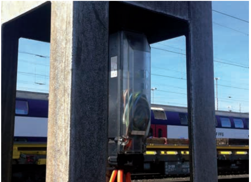
Umfangreiche Powerline Signalmessungen im Bahnbereich (16 2/3 Hz) lieferten einwandfreie Kommunikationswerte. Dies ist ein Beispiel für eine Komponente (F) gem. Bild Anlageprinzip.
